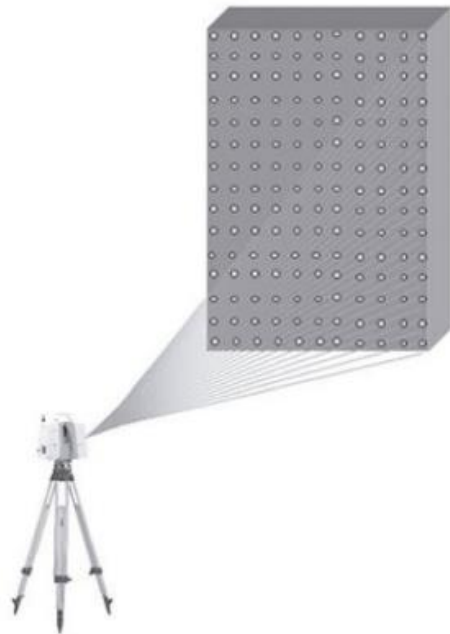
Princípio de funcionamento de um scanner a laser terrestre
